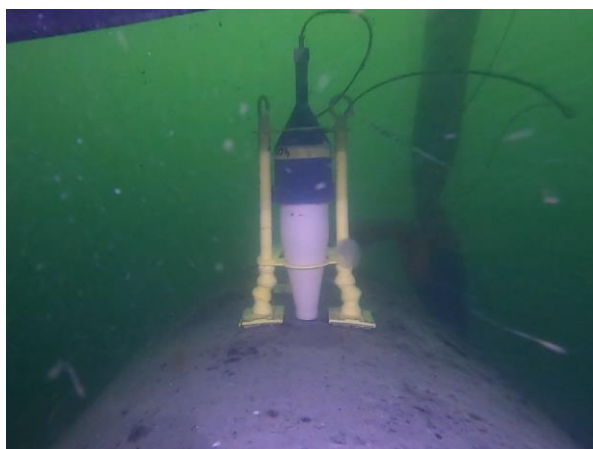
Rys 3. Zamocowanie ładunku kumulacyjnego na korpusie bomby. Źródło: Grupa Nurków Minerów 12.dTR.
